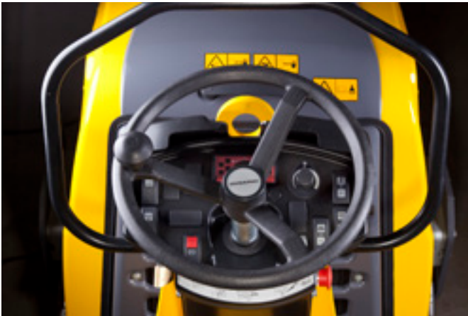
Einfach abzulesendes Armaturenbrett mit Kraftstoffanzeige. Sehr niedrige Vibrationswerte auf dem Fahrerstand.
