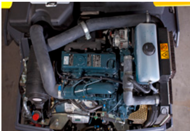
Leiser und leistungsstarker Kubota Dieselmotor mit Wasserkühlung. Große Motorhaube für hervorragende Zugänglichkeit.
