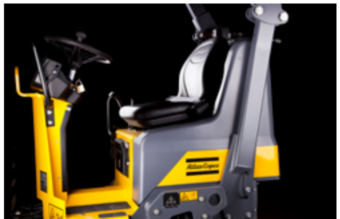
Geräumiger und vibrationsgedämpfter Fahrerstand mit Komfortsitz und dualem Fahrhebel (optional) für optimalen Bedienerkomfort.
