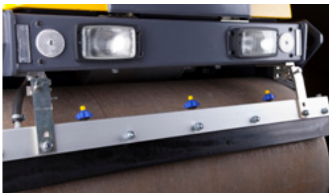
Druckberieselungssystem mit leistungsstarker Wasserpumpe und selbstlenkernden Schläuchen und Düsen.
