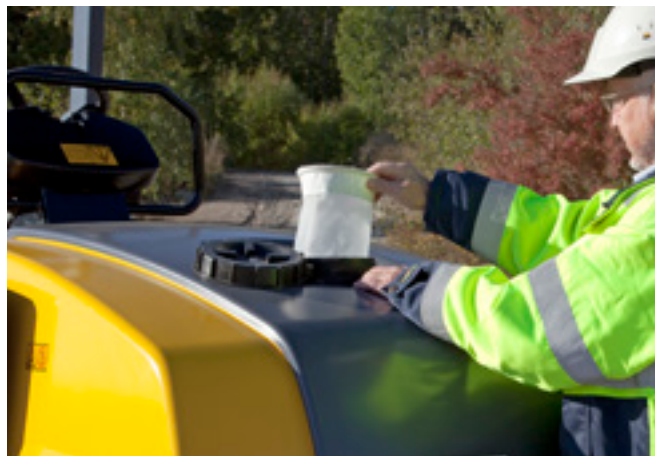
Großer Einfüllstutzen für leichtes Befüllen des Wassertanks.
