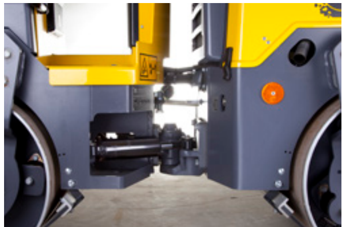
Lange Serviceintervalle und wartungsfreie Lenkzylinder reduzieren den Wartungsaufwand auf ein Minimum.
