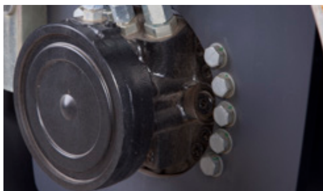
Die ausfallsicheren Bremsen an beiden Bandagen (Kombirädern) reagieren automatisch bei Störungen des Motors, des Hydrauliksystems oder der Brems elektrisch.
