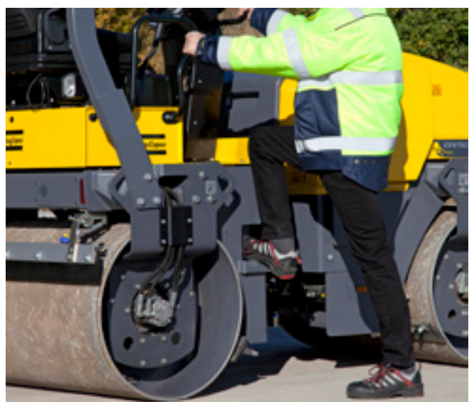
Stabile Handgriffe und ergonomische Stufen für sicheren Aufstieg.
