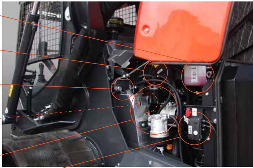
In der rechten hinteren Ecke sind die Steuerungen für den hydraulischen Hub der Kabine angeordnet.
