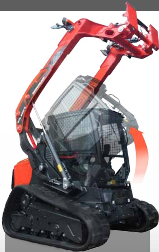
Das Kippen der Kabine mit hydraulischer Steuerung erlaubt, den Verteiler und die hauptsächlichen Komponenten der Hydraulikanlage bequem zu erreichen: Wenige Gesten für einen zusätzlichen Wert.
