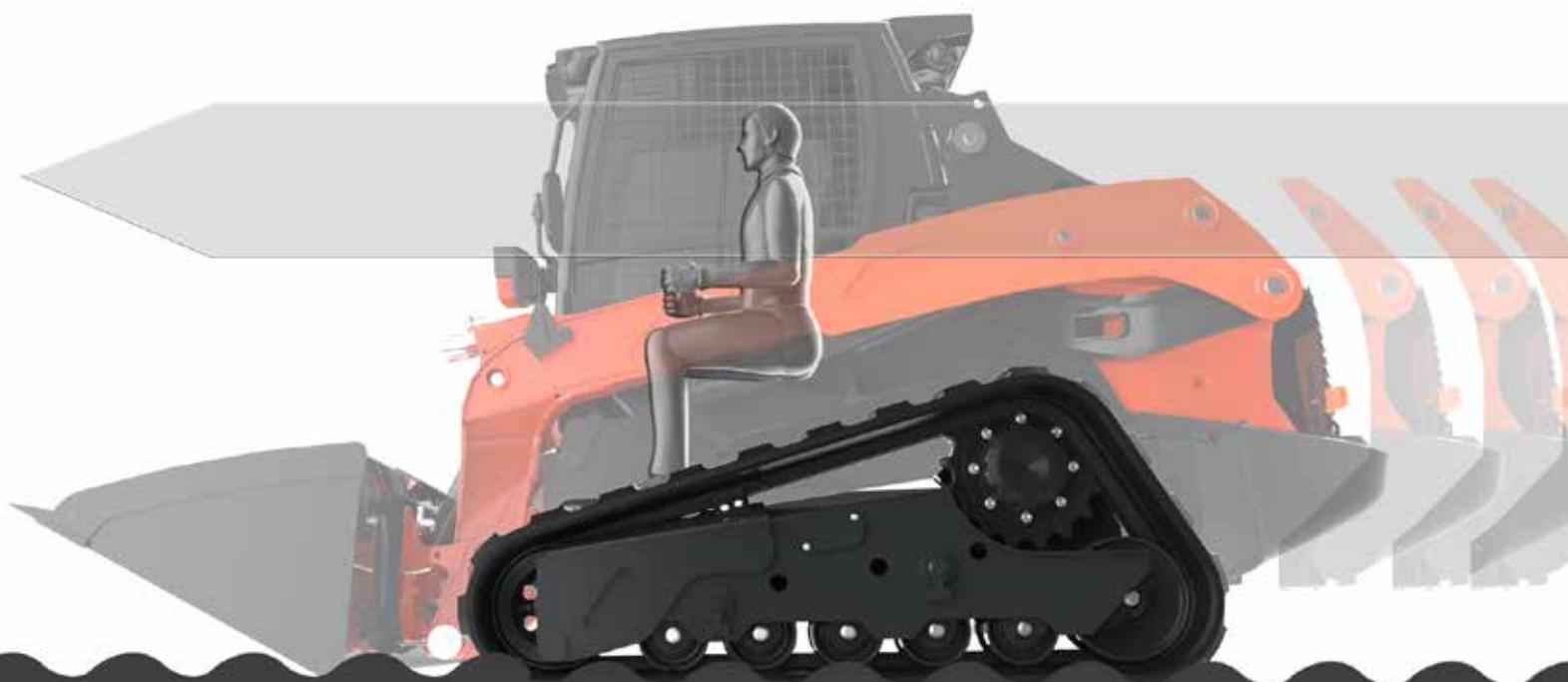
Die Kabine, die den ROPS / FOPS - Sicherheitsanforderungen entspricht, bietet einen großen Arbeitsbereich und erhöht so den Komfort und die Produktivität in den Arbeitstagen. Sie ist mit einem Sitz mit mechanischer Federung (optional zu demjenigen mit pneumatischer Federung, auch erwärmt) mit System für die Sitzlängsverstellung ausgestattet.
