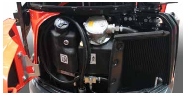
Elektropumpe Einfüllung Dieselkraftstoff
