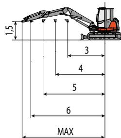
Hebekraft basierend auf ISO-Norm 10567 und überschreitet nicht mehr als 75% der Kipplast oder 87% der hydraulischen Hebe-Kapazität der Maschine.
